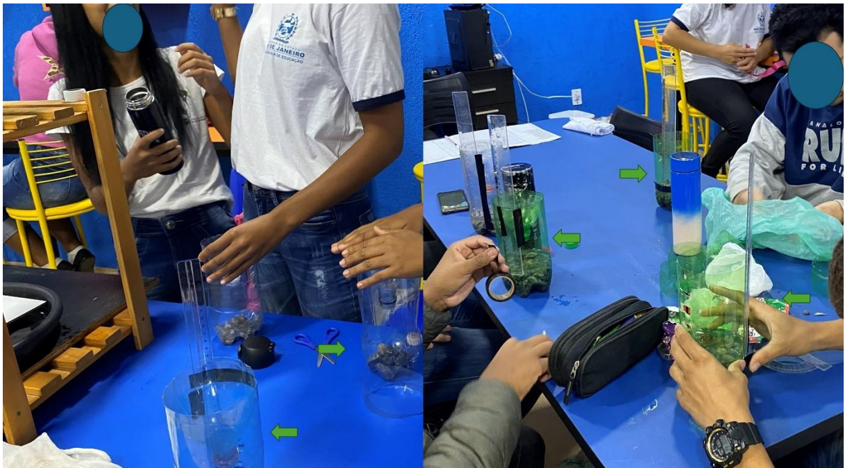
Figura 27: Pluviômetros com reservatórios não lisos
