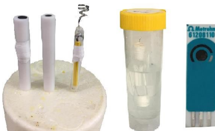
Figura 9 – Fotografia dos eletrodos utilizados nos experimentos. Da esquerda para direita: eletrodo de grafeno, eletrodo de carbono pirolítico, contra eletrodo de platina, eletrodo de referência e eletrodo impresso.
