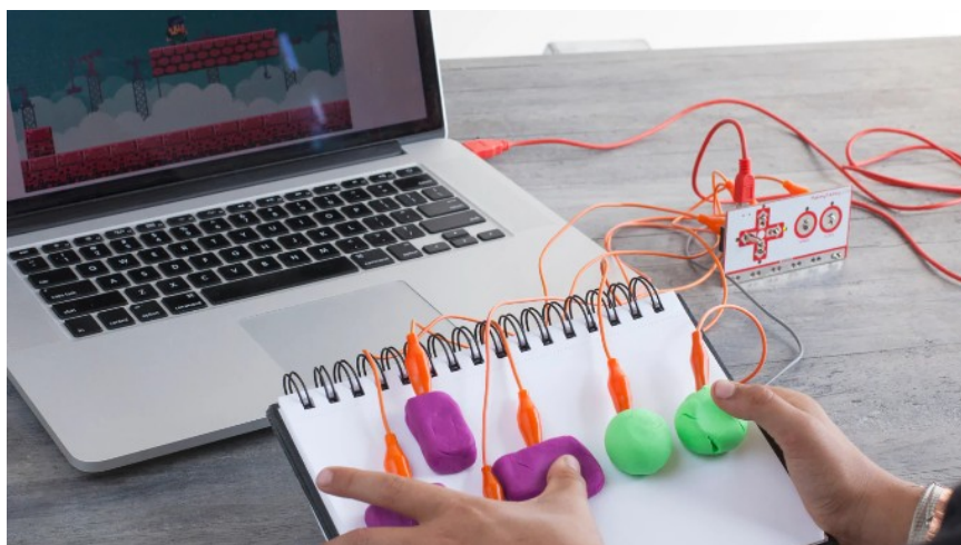
Figura 03 – Microcontrolador Makey Makey
