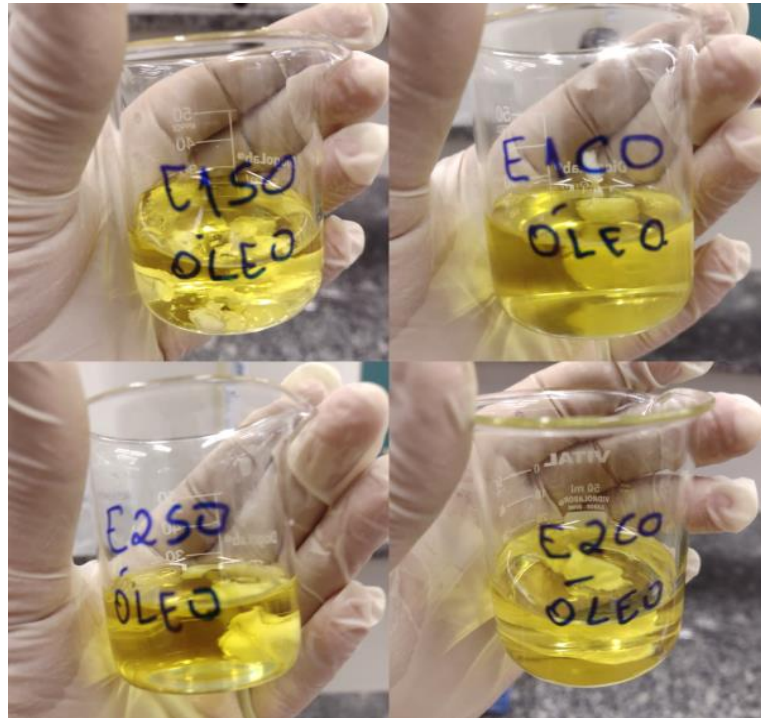
Figura 11: Teste de miscibilidade da emulsão realizado em óleo de maracujá.
