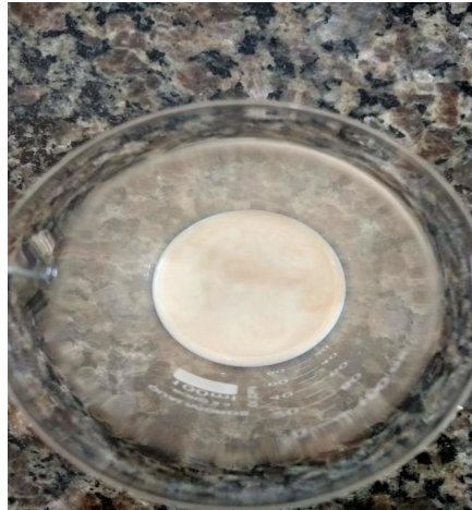
Figura 8: Resultado da adição de alizarol à amostra não contaminada.
