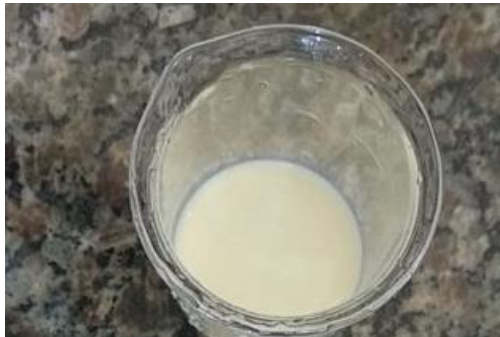
Figura 7: Resultado da adição de alizarol à amostra contaminada com ácido.
