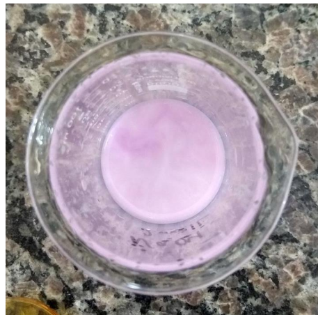
Figura 9: Resultado da adição de alizarol à amostra contaminada com base.
