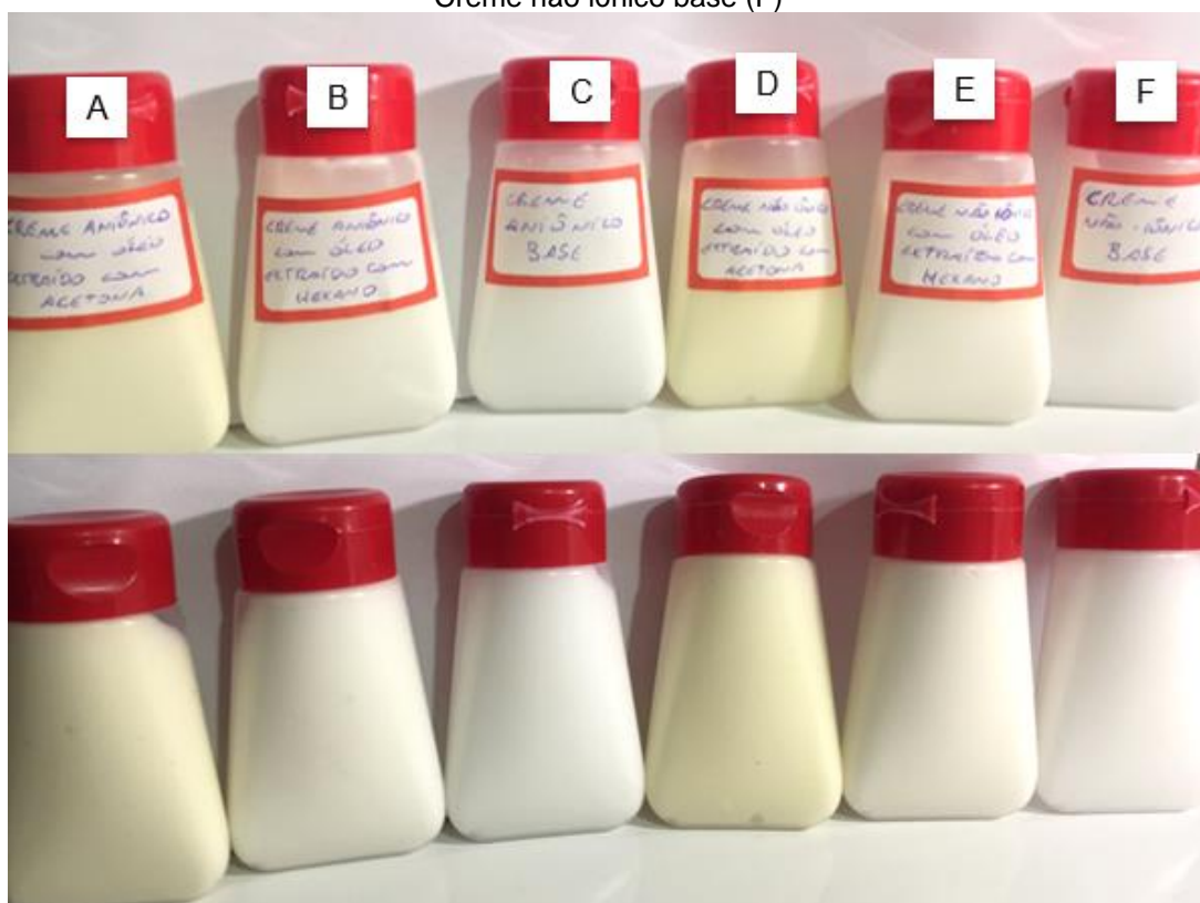
Figura 10- Período de 90 dias das formulações; Creme aniônico com óleo extraído com acetona (A); Creme aniônico com óleo extraído com hexano (B); Creme aniônico base (C); Creme não iônico com óleo extraído com acetona (D); Creme não iônico com óleo extraído com hexano (E); Creme não iônico base (F)
