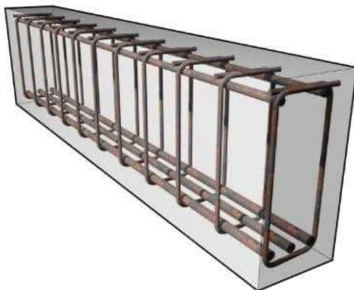
Figura 1: Viga de Concreto Armado Fonte: MENEGHEL, 2022
