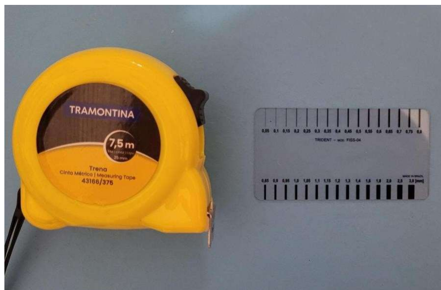
Figura 3: Instrumentos de medição utilizados (trena métrica e fissurômetro, consecutivamente) Fonte: Acervo da autora, 2023
