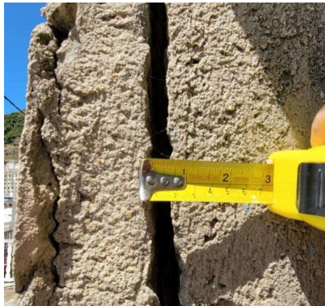
Figura 8: Medição de abertura em estrutura de concreto armado utilizando trena métrica Fonte: Acervo da autora, 2023
