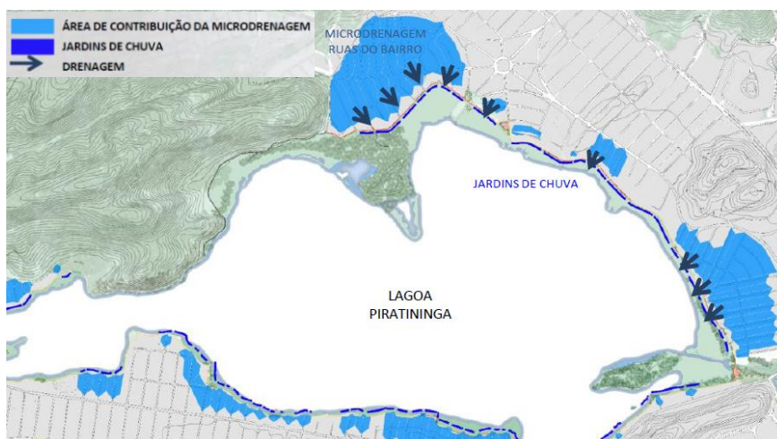
Figura 5: Localização dos jardins de chuva e indicação das áreas de microdrenagem abrangidas.
