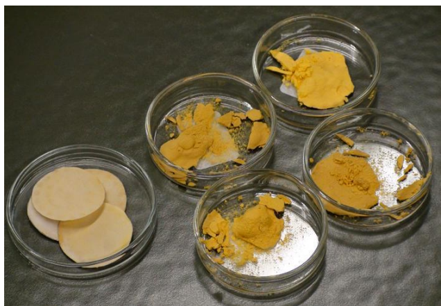
Figura 19 – Produto após filtração e secagem
