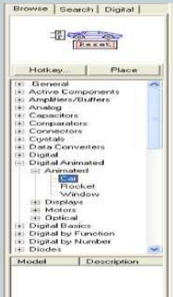
A esquerda temos algumas das opgoes uteis para a interface com o cliente. No exemplo selecionado, quando ativado o carro parte para a direita em movimento acelerado. O mesmo acontece com o foguete, ja a janela e util para indicar a sinalizagao de um sensor sendo disparado.
