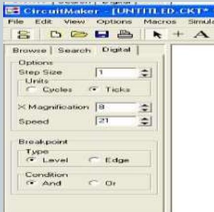
Quando rodamos a simulação aparece uma nova opção a ser selecionada à esquerda, dentro das opções da nova janela há, por exemplo, a opção para mexer na velocidade da simulação. Essa opção será útil quando estivermos trabalhando com um gerador de pulsos automático, caso a velocidade de simulação não seja reduzida será impossível observar o funcionamento do sistema.
