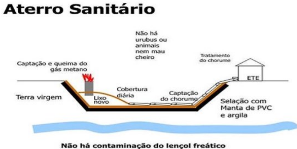
Figura 6 - Esquema de um aterro sanitário
