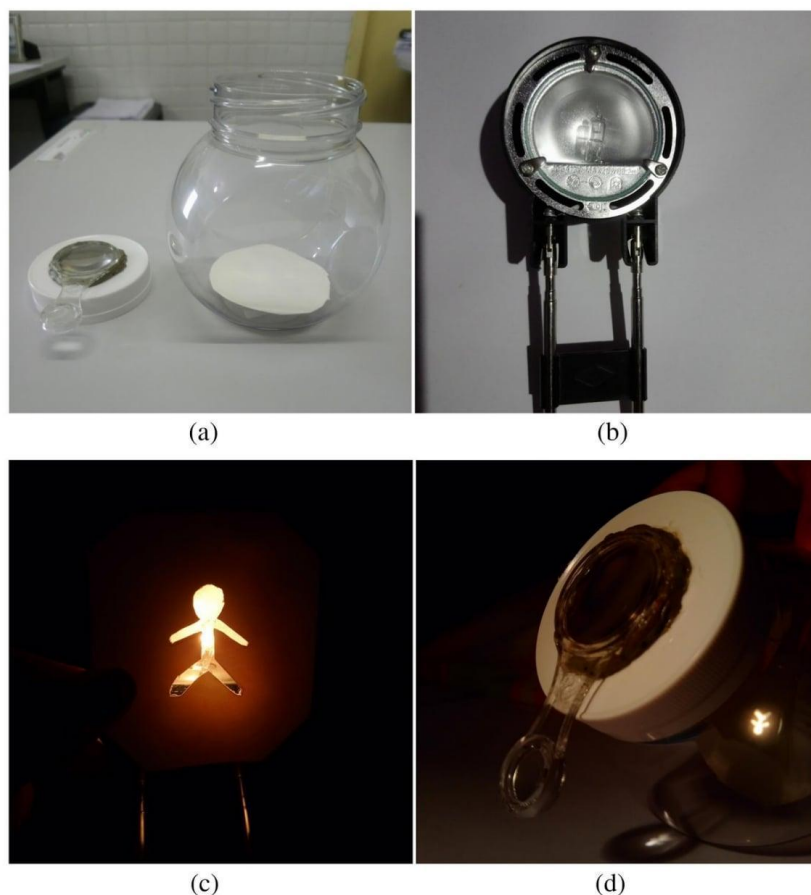
Figura 5.9: Baleiro e lentes usados para a simulação do olho (a), a lâmpada halógena (b), o cartão vazado que serviu como objeto (c). Foto com a imagem invertida projetada no papel (d).
