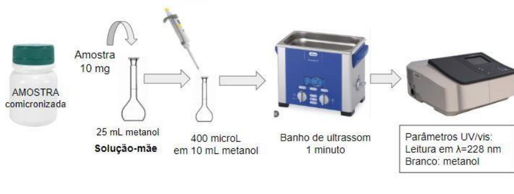
Figura 13 - Esquema ilustrativo do preparo da solução mãe a partir das amostras comicronizadas em meio metanol e sua diluição para análise e leitura no comprimento de onda 228 nm (Fonte: elaborado pela autora, 2022).
