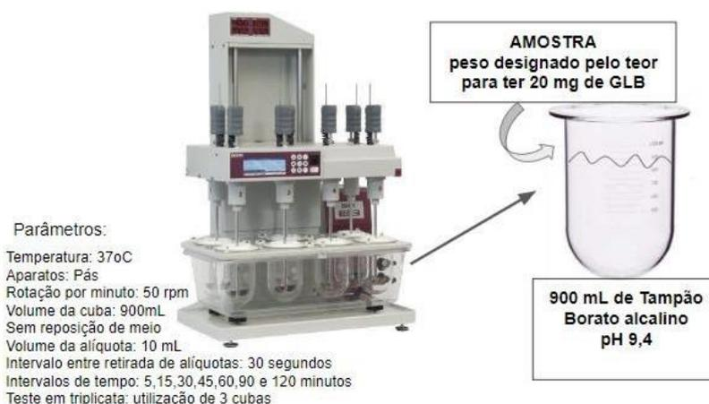
Figura 15 - Dissolutor Distek Premiere 5100 com os parâmetros utilizados na dissolução por dispersão das amostras comicronizadas em tampão borato alcalino pH 9,4 (Fonte: elaborado pela autora, 2022).
