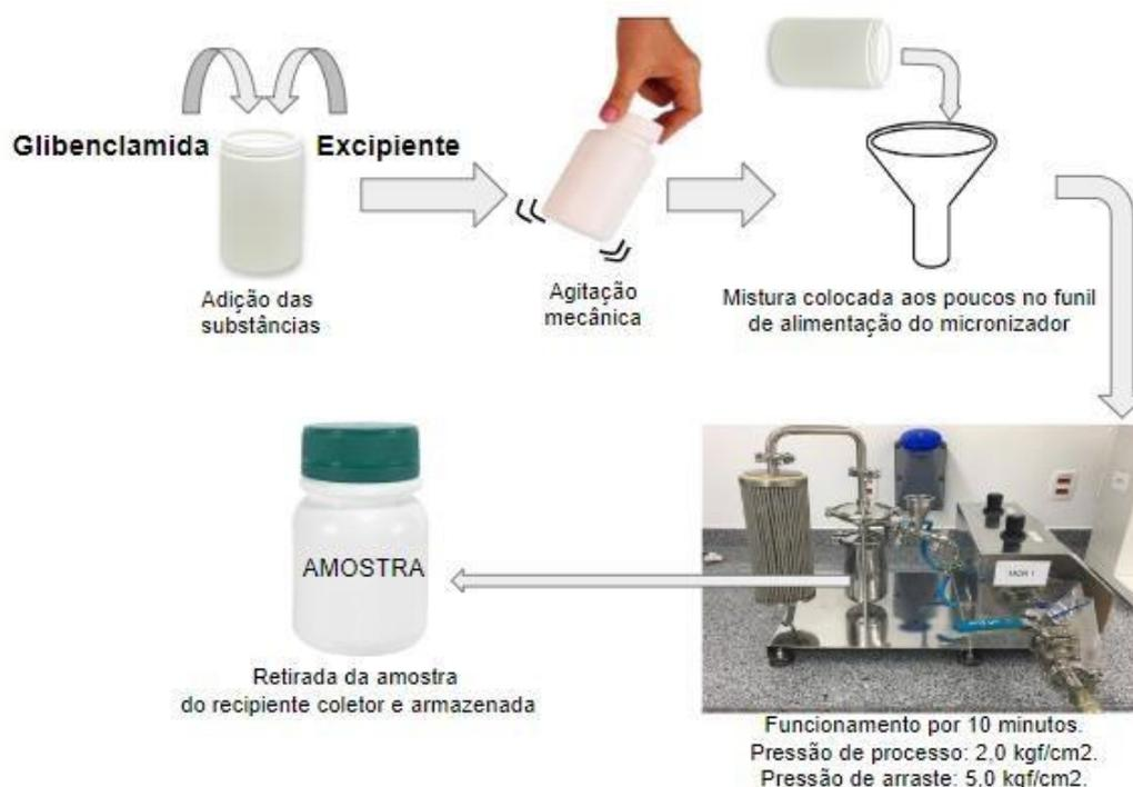
Figura 11 - Esquema ilustrativo indicando a mistura da GLB com os excipientes para ser comicronizado no micronizador Zelus Ultrajet 50 e produzindo as amostras do projeto (Fonte: elaborado pela autora, 2022).
