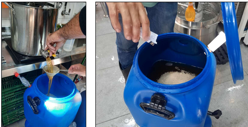
Figura 18: Transferência para bombona e inoculação da levedura.
