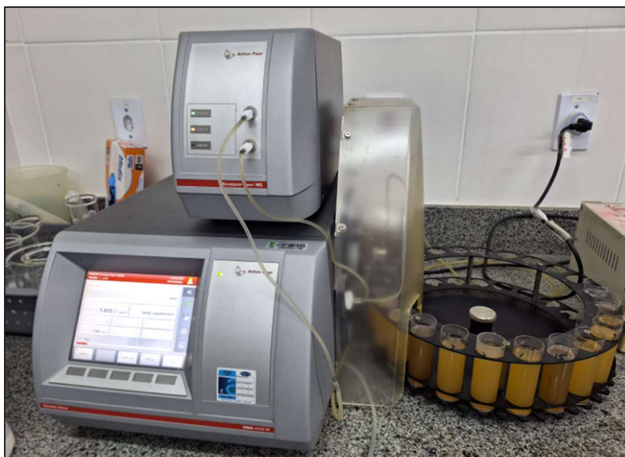
Figura 22: Aparelho Alcolyzer utilizado nas análises de cervejas.
