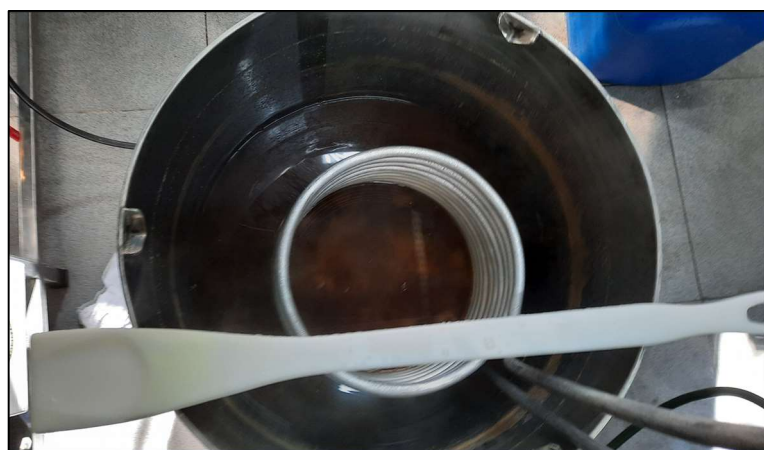
Figura 17: Pá utilizada no Whirlpool e serpentina para resfriamento.
