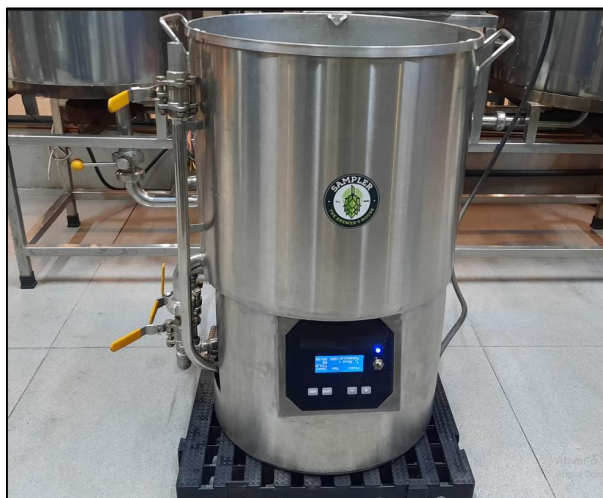
Figura 14: Equipamento utilizado na brassagem ( single vessel ).
