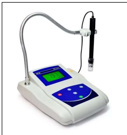
Figura 24: Aparelho pHmetro utilizado nas análises de pH.
