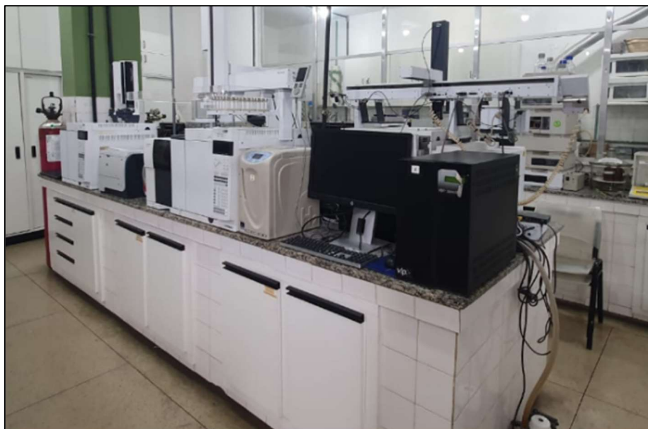
Figura 28: Cromatógrafo gasoso utilizado nas análises de voláteis.
