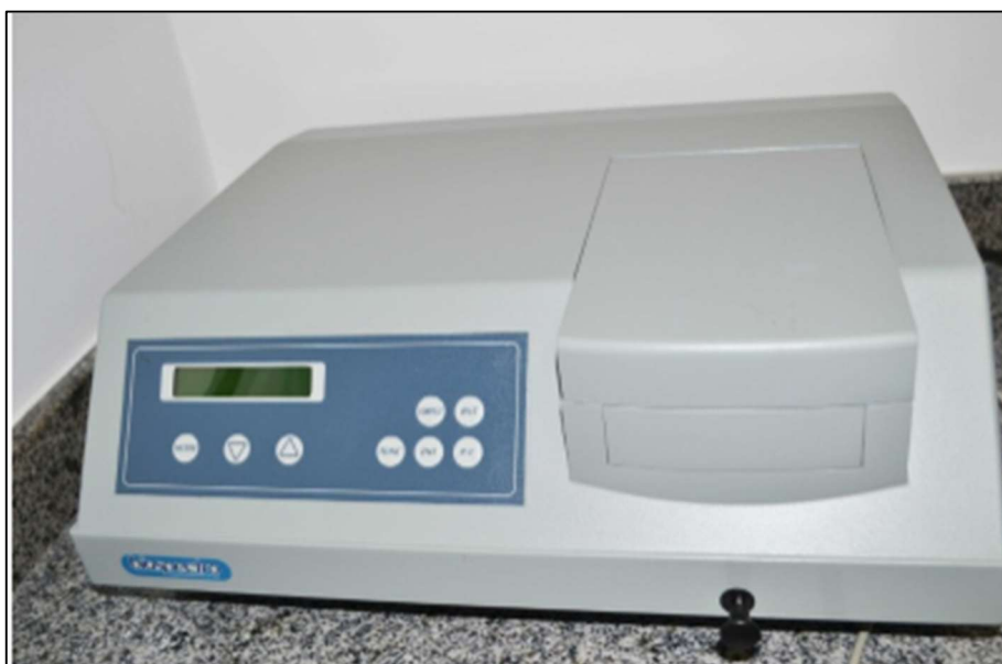
Figura 26: Espectrofotômetro utilizado nas análises de amargor.
