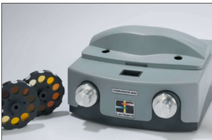
Figura 25: Colorímetro utilizado nas análises de cor.
