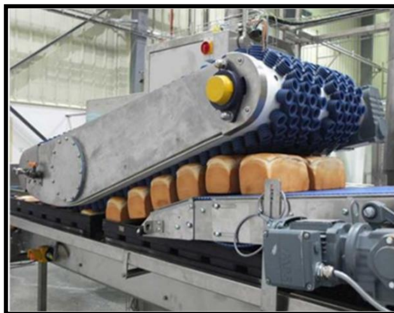
Figura 9: Etapa de retirada dos pães das formas por sucção.
