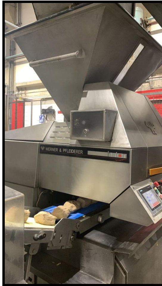
Figura 4: Etapa de divisão da massa realizada pela Divisora.
