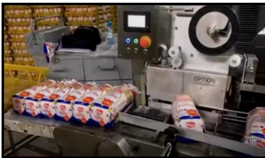
Figura 13: Etapa de fechamento na Lacradora ou Fitolhador.
