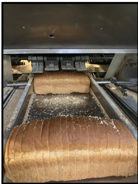
Figura 11: Etapa de fatiamento dos pães de forma na Fatiadora.
