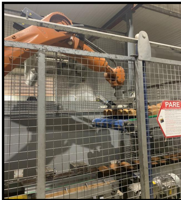
Figura 8: Etapa de retirada dos pães das formas por pinçamento.
