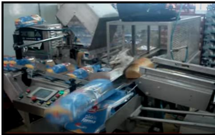
Figura 12: Etapa de embalagem dos pães de forma na Embaladora.
