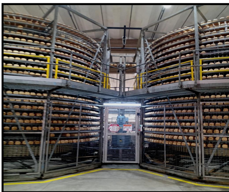
Figura 10: Etapa de resfriamento dos pães de forma no Resfriador.
