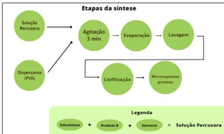
Figura 10 - Etapas da metodologia de evaporação de solvente.
