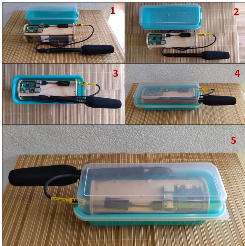
Figura 3.6: Fases de montagem do EA-2.
