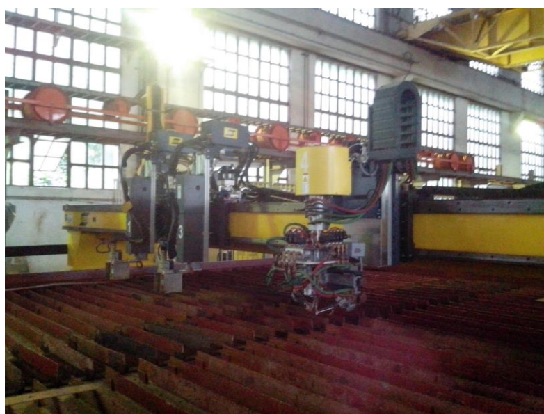
Figura 2 - Vista de frente da Máquina de Corte plasma e Oxicorte Fonte: Elaborada pelo autor
