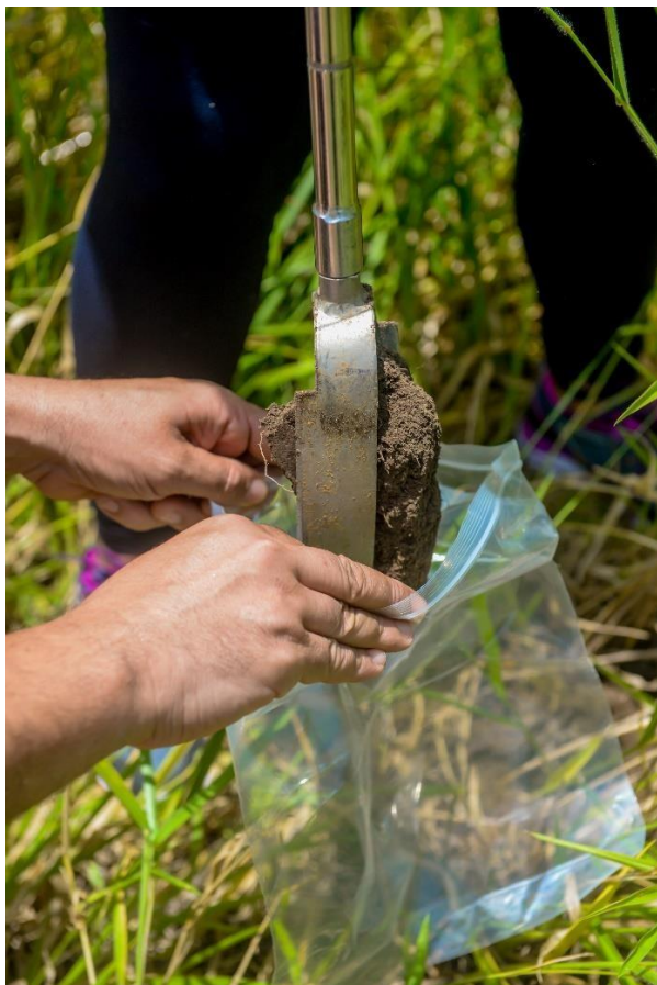
Apêndice 5. Coleta: saco plástico com zíper e trado manual para extração de solo (Fotos: Jacqueline Matos, 2022).
