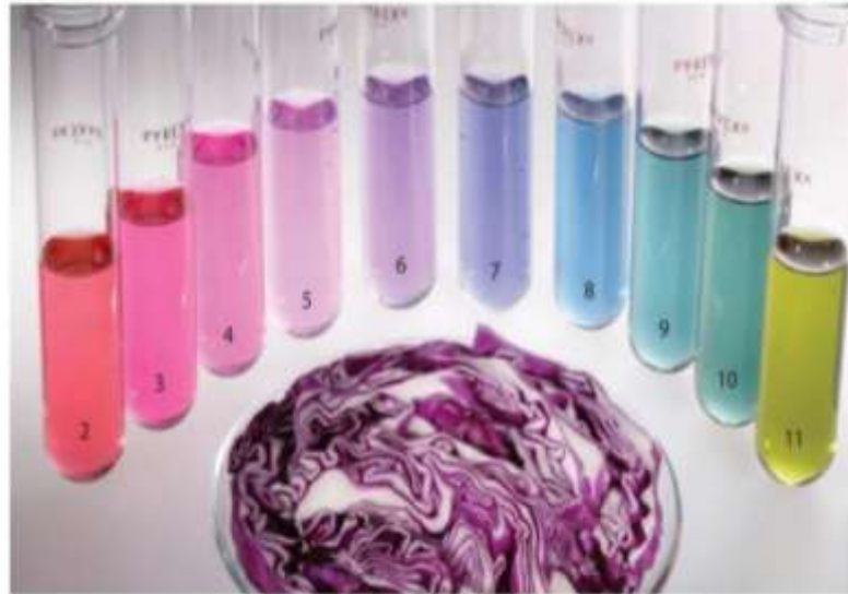
Figura 1- Escala de pH de 2 a 11 e a adição do indicador repolho roxo.
