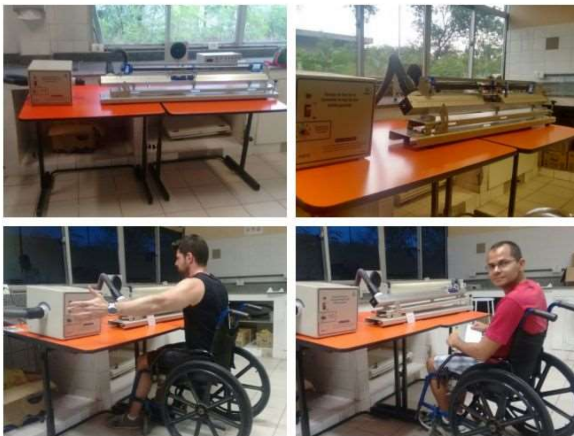
Figura 8. Trilho de ar sobre as mesas de cadeirante (à cima) e os professores simulando a realização do experimento em cadeira de rodas (à baixo).
