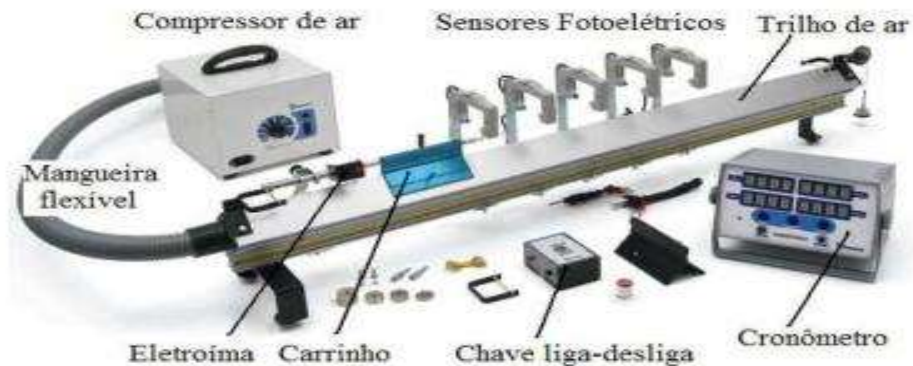
Figura 1: O trilho de ar e seus componentes.
