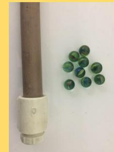
Figura 57. Parte de baixo do tubo, com luva de PVC e redução acoplada. Bolinhas de gude que serão colocadas dentro.
