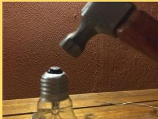
Figura 12. Bocal da lâmpada, parte preta (cerâmica), local aonde será martelada várias vezes de forma contínua mas de forma leve.
