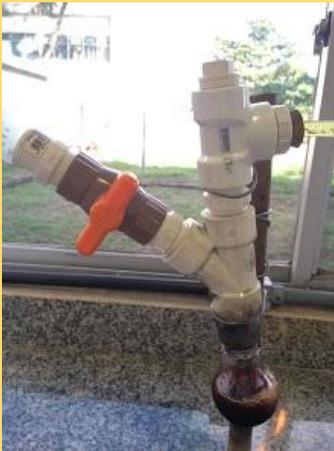
Figura 62. Montagem das partes de tubulação para o arraste a vapor.
