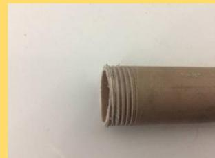
Figura 47. Tubo de PVC após abrir rosca em uma das extremidades.
