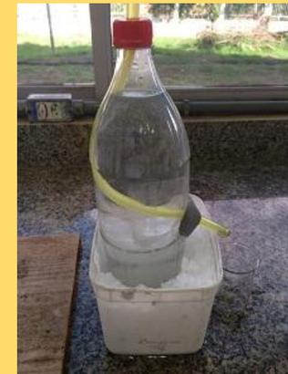
Figura 27. Condensador dentro de um pote de sorvete com gelo.
