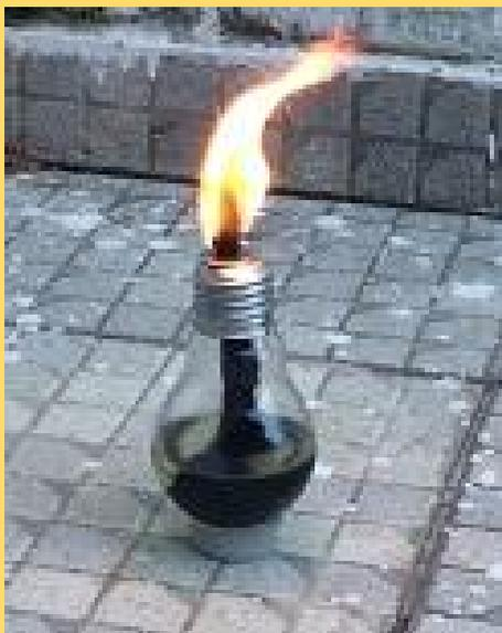
Figura 34. Lamparina acesa com álcool comercial pouco hidratado.
