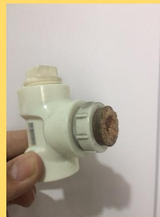
Figura 18. Vista do T-PVC com rolha de cortiça furada e plug.
