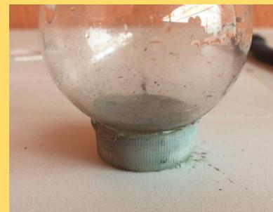
Figura 31. Tampinha de garrafa preenchida com massa epóxi e presa na parte de baixo da lâmpada.
