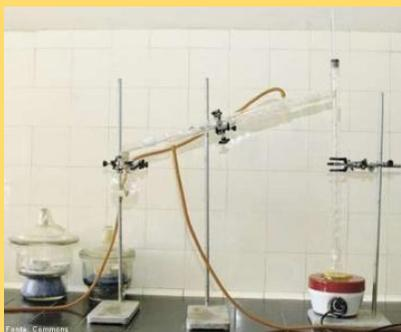
Figura 43. Vidraria de destilação fracionada.<sup>8</sup>
