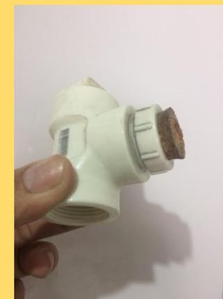
Figura 19. Vista do T-PVC com rolha de cortiça furada e plug.
