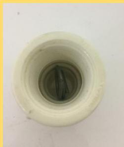
Figura 55. Vista superior da luva de PVC com arame por dentro.
