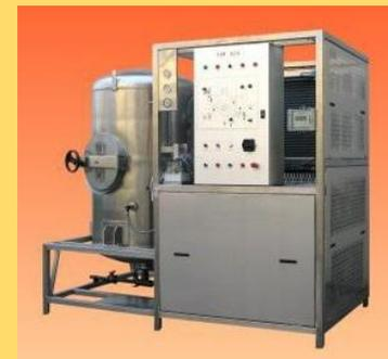
Figura 05. Evaporador industrial.<sup>6</sup>
