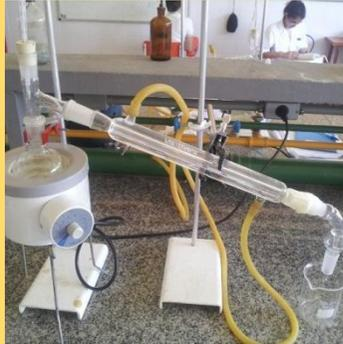
Figura 06. Destilação simples com materiais convencionais.
