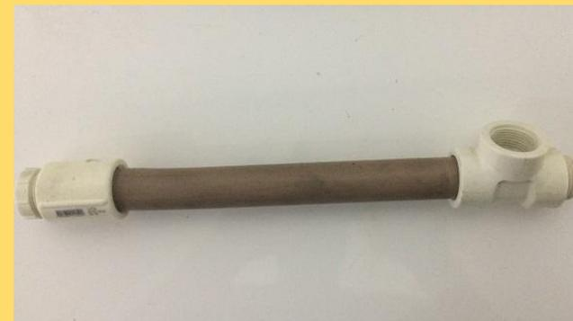
Figura 58. Tubo com a luva de PVC de um lado e do T-PVC do outro.
