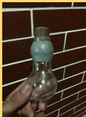
Figura 17. Lâmpada e redução presas por massa epóxi
