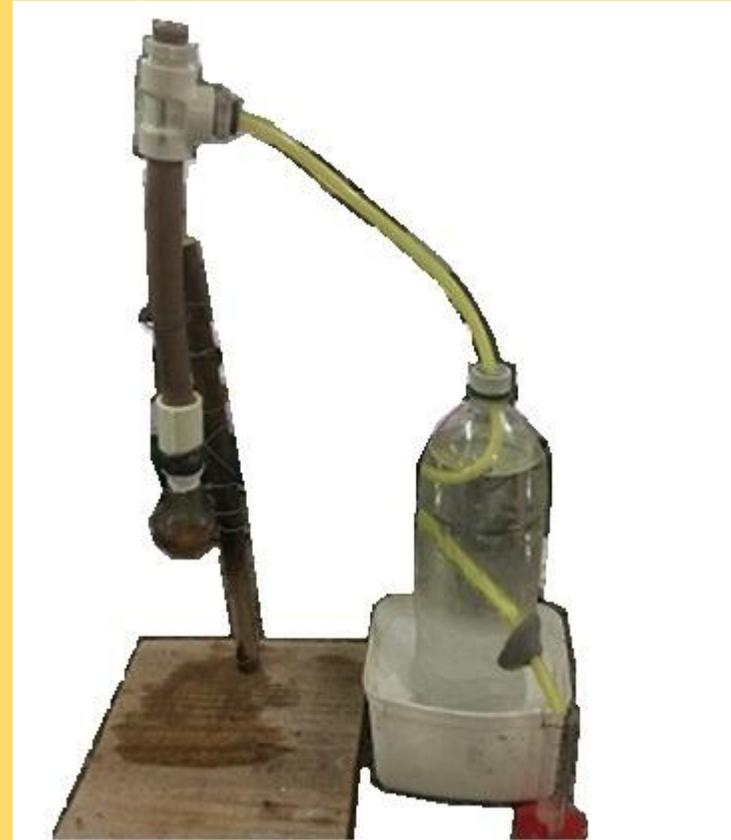
Figura 68. Destilação fracionada.
